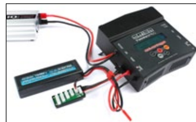
Connection batterie LiPo 2S avec fiches Deans et XH
