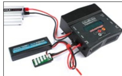
Connessione batteria LiPo 2S con spine Deans e XH
