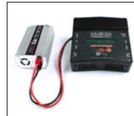
Anschluss der Stromquelle
