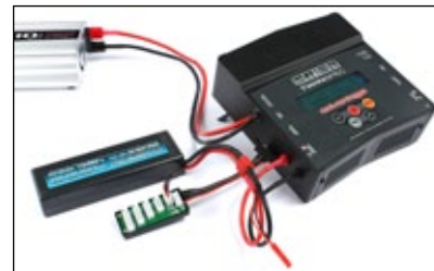
Anschluss eines 2S Akkus mit Deans und XH Steckern
