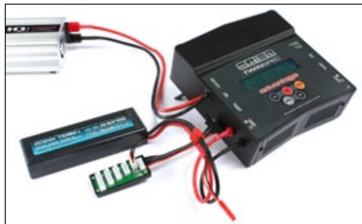
Connexion batterie LiPo 2S avec fiches Deans et XH
