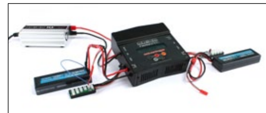
Chargeur avec 2 batteries LiPo raccordées
