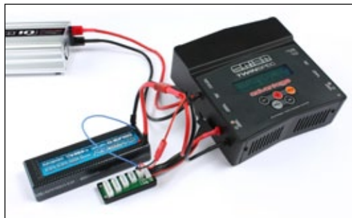
Connexion batterie LiPo 2S avec fiches dorées 4mm et 2mm
