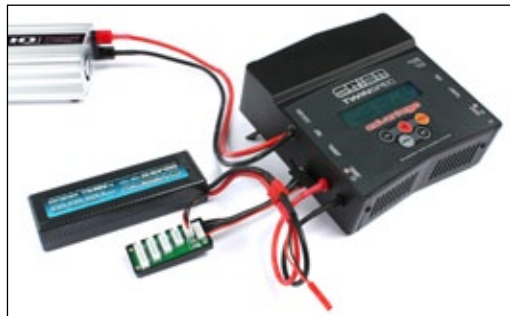
Connessione batteria LiPo 2S con spine Deans e XH
