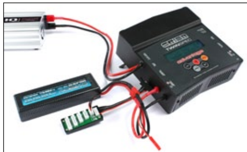
Anschluss eines 2S Akkus mit Deans und HX Steckern
