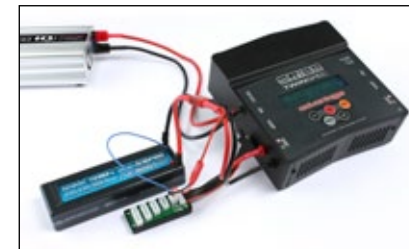
Anschluss eines 2S Akkus mit 4mm und 2mm Goldsteckern
